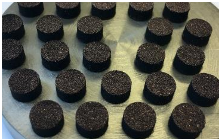
石墨烯改性铜粉测试件 © Uppsala University
