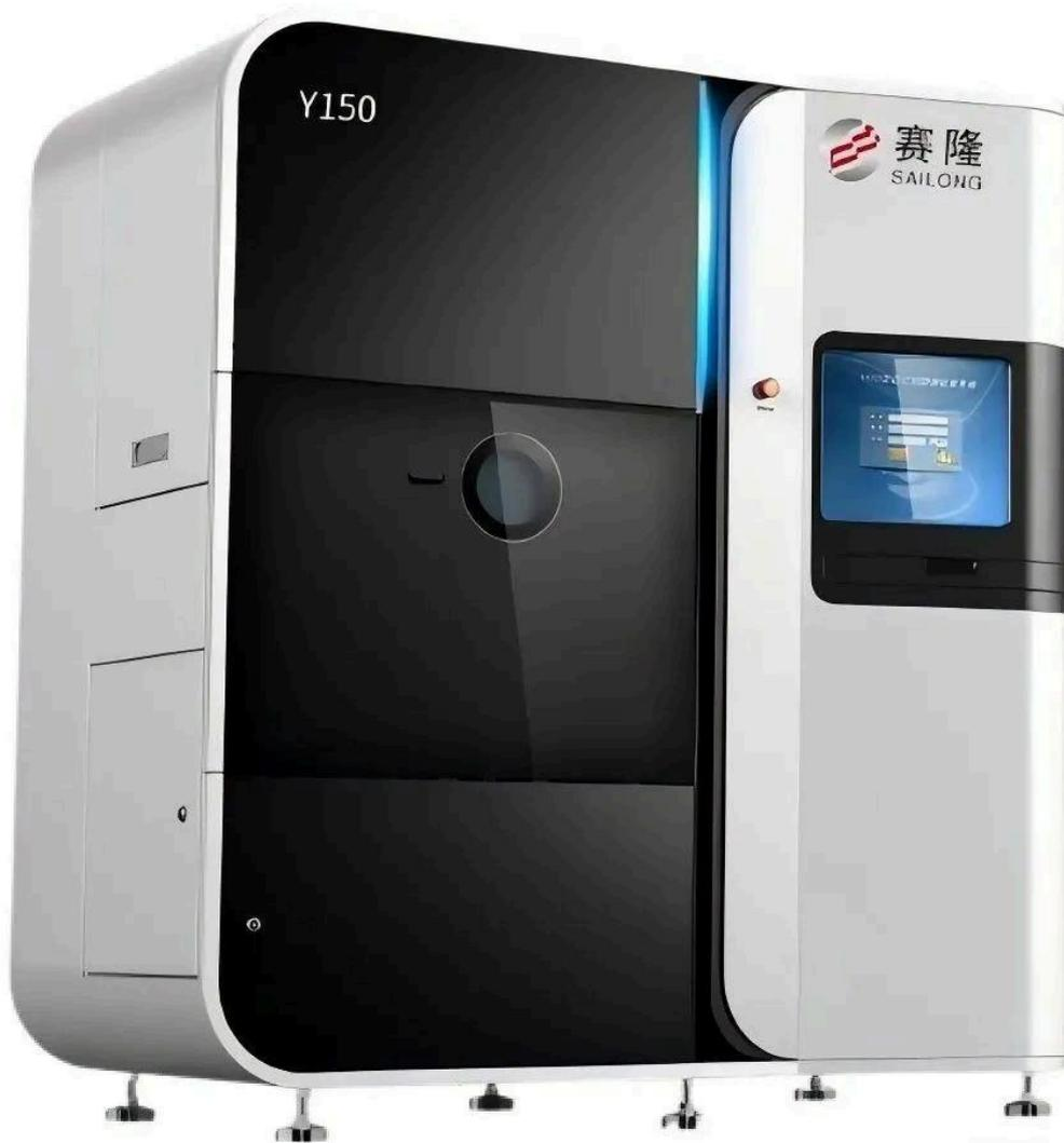
Sailong Y150采用**电子束粉末床熔融技术**，最大成形尺寸150×150×180 mm，成形工艺开源，**开发新材料体系方便快捷**。可打印钛及钛合金、难熔金属(钨、钼、钽、铌等)及合金、钛铝等脆性难加工材料、铜及铜合金、锆合金、镍基高温合金、陶瓷/金属复合材料，**适用于高校、科研院所进行新材料开发和小批量生产**。
