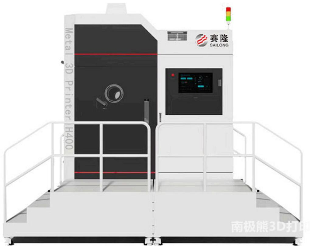
Sailong H400采用电子束粉末床熔融技术，最大成形尺寸400×400×400 mm，搭载自主创新的大功率、长寿命的间热式电子枪，电子枪功率10kW，大幅提升零件成形效率。可打印钛及钛合金、铜及铜合金等材料，适用于航空航天、核工业、兵器、汽车等行业大尺寸复杂结构零件的快速制造及中小型复杂零件批量制造。
