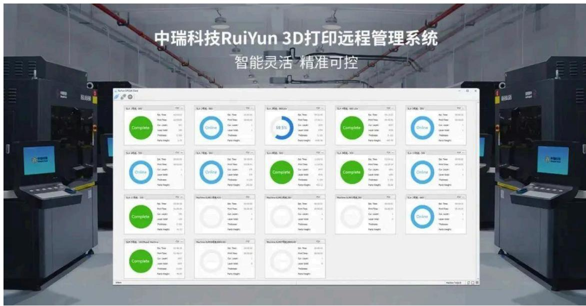
RuiYun 3D打印远程管理系统软件，能实时监控3D打印设备的运行数据、生产进度、工件质量和设备使用情况等信息，可视化页面直观呈现设备运行状态，用户可通过手机端或PC端获取实时信息，随时随地掌握工厂动态，并能通过对生产数据的分析，把控工件打印质量、优化生产流程、合理安排生产任务，实现对生产过程的全方位监控和管理，确保生产效率最大化，进一步提升了生产的灵活性和智能化水平，提高了生产效率和产品质量，助力工业用户实现高度自动化的生产流程和精细化管理。
