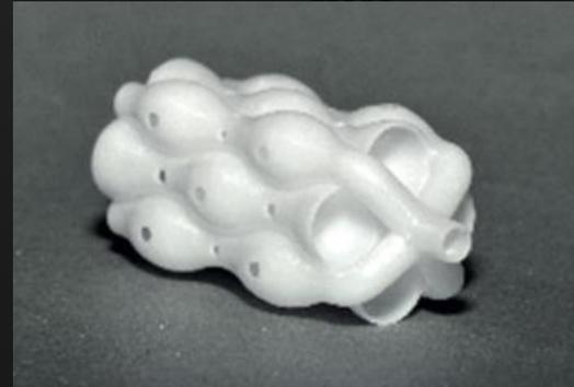
3D打印的静态混合器中的管内部混合单元，表面粗糙度达到 $0.4\mu\text{m}$ 左右。
