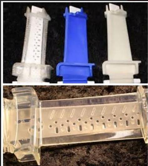
**粘结剂喷射技术3D打印陶瓷模具**
