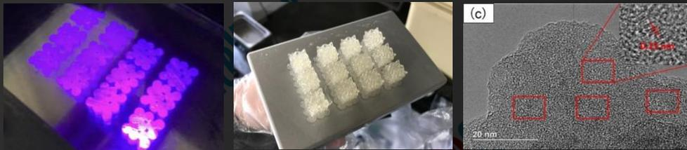
高温裂解后陶瓷样品出现一定量的纳米晶；
