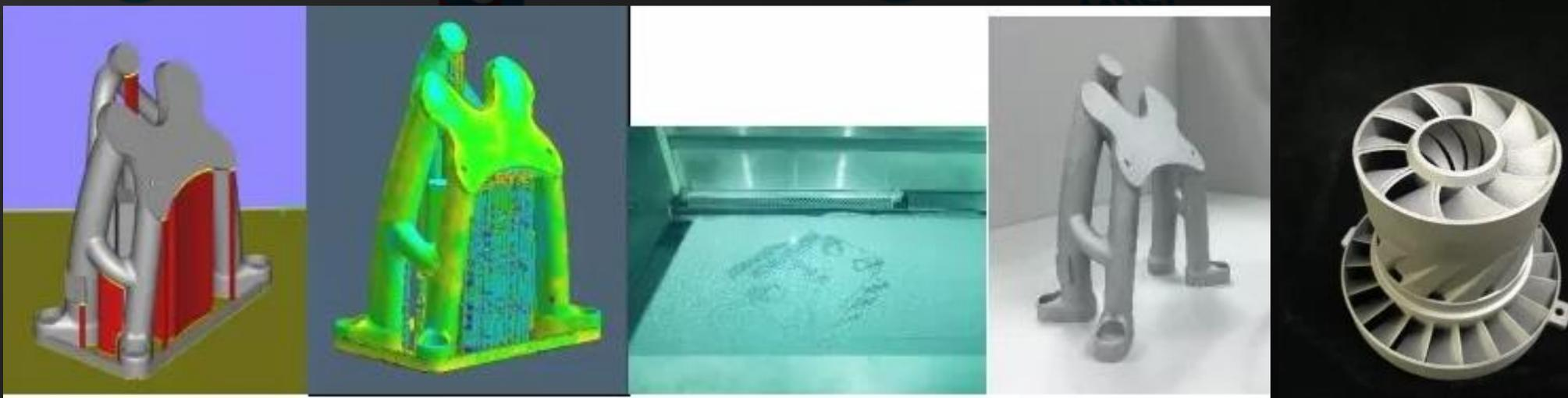
赛峰发动机润滑装置先前是在铸造厂生产的，赛峰航天推进器公司的研究和研发团队开发了一种新设计的润滑装置外壳，其设计针对增材制造进行了优化。目前赛峰航天推进器公司 (Safran Aero Boosters) 3D打印的LEAP发动机润滑装置已获得EASA1和FAA2适航当局的认证。
