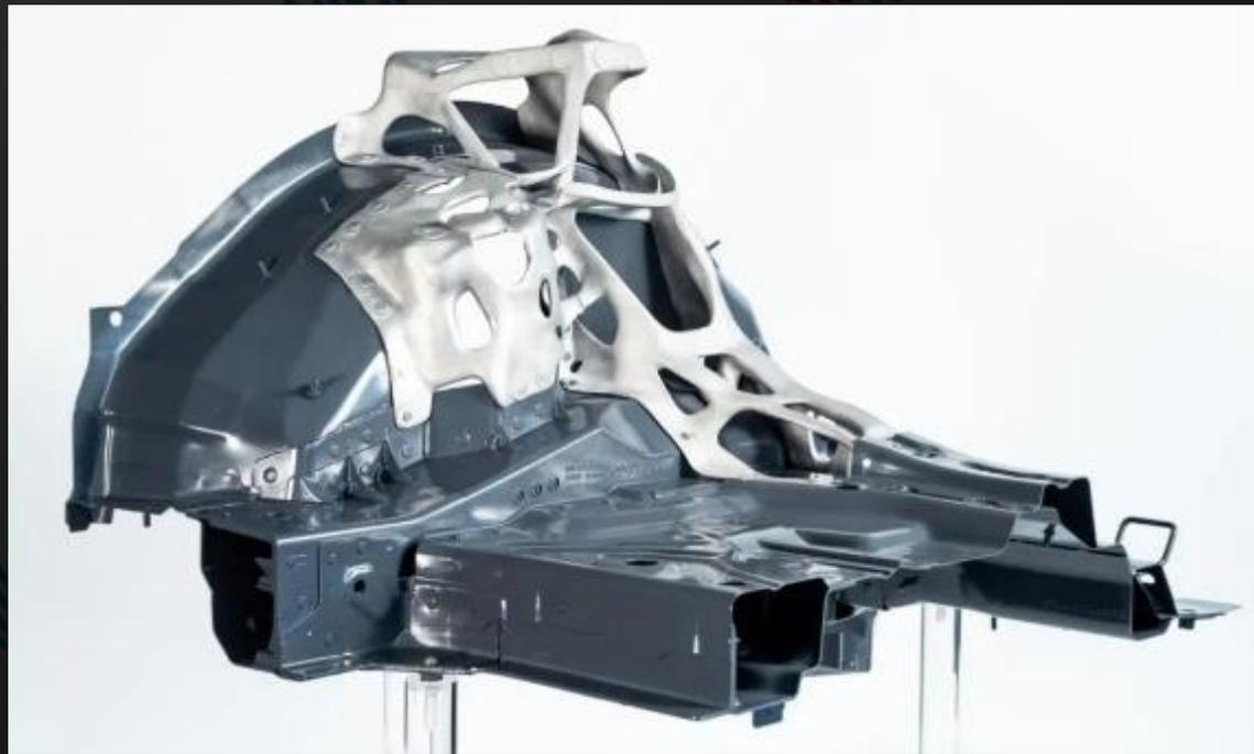
在八家合作伙伴中, Fraunhofer研究所 ( IAPT)、GE 增材制造 (GE Additive) 开展的工作是基于粉末床激光熔化 (LBM) 技术进行这种新型铝合金材料的增材制造工艺开发。Fraunhofer研究所 ( ITWM) 对增材制造过程中材料快速冷却进行了仿真模拟。汽车制造商梅赛德斯·奔驰和EDAG在仿真企业Altair的支持下, 开展了性能仿真。
