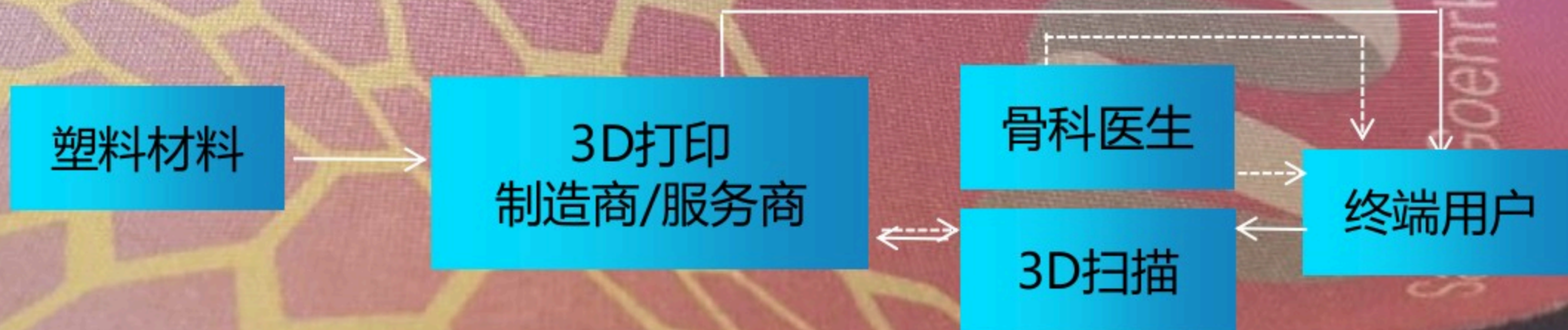
3D打印矫形鞋垫制造供应链示意图
