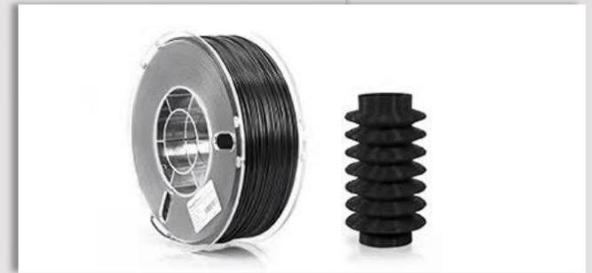
TPU (热塑性聚氨酯) 是一种柔性和有弹性的热塑性3D打印耗材。它具有类似橡胶的弹性，有不同的软硬范围可以选择，并且具有耐磨性和耐油性。TPU易于打印，打印台基本不需要加热，TPU具有良好的柔韧性和弹性，适合打印需要冲击吸收和柔软触感表面的模型，例如管子，密封件，衬套、减震器和可穿戴电子产品，鞋类产品等。
