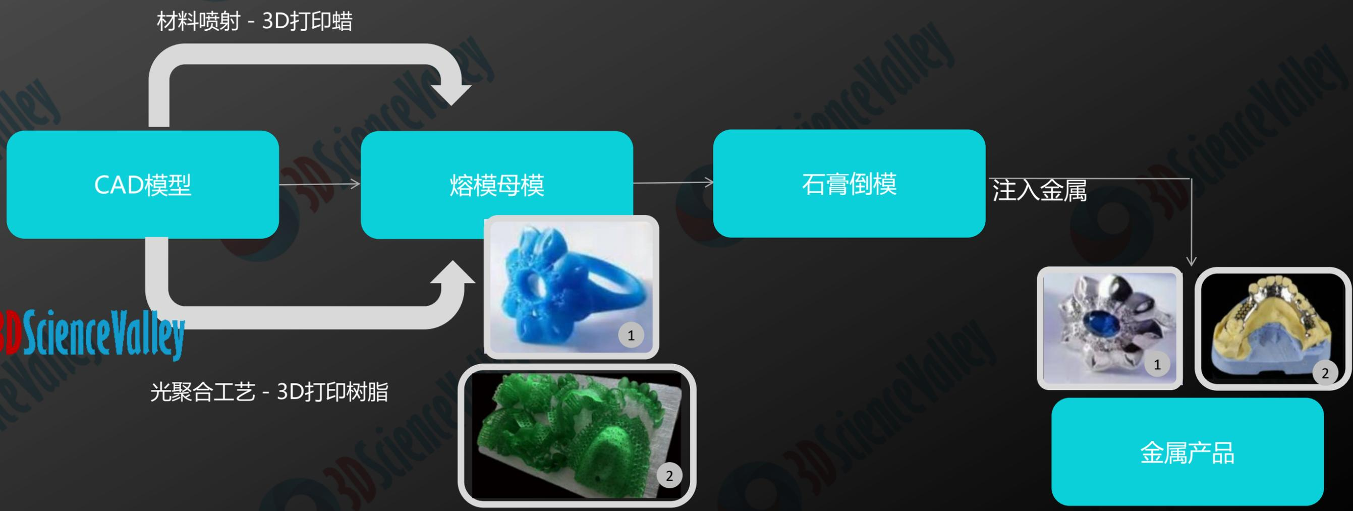
图片：1. 3D打印首饰熔模母模，铸造的金属首饰，来源：Formlabs；2. 3D打印义齿支架熔模母模，铸造的金属支架，来源：先临三维。
