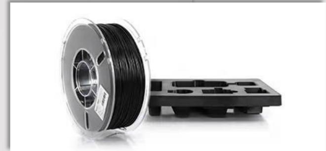
PET-G(聚对苯二甲酸乙二酯)是PET的一种共聚改性体。G代表PET的乙二醇分子链被改性变成共聚高分子，因此PETG具有更高的透明性、耐久性、加工性、抗收缩性、尺寸稳定性和耐化学性。PET-G具有很好的流动性，也不需要非常高的打印底板温度，打印效果和细节非常优异，也可以进行纤维加强，运用非常广泛，例如：工程设计，原型设计，功能测试，零件组装，玩具和装饰品。
