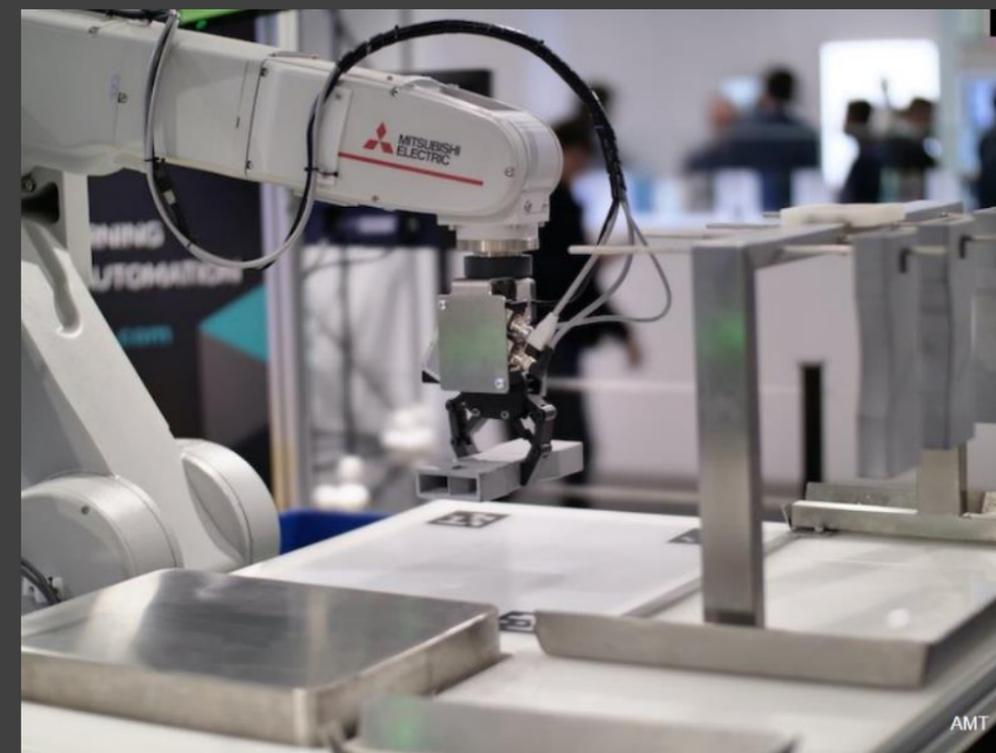
AMT 在聚合物3D打印零件表面处理平台 PostPro 3D 中集成三菱电机的机械臂，六轴机械臂将3D打印零件装进后处理机器或从中取出，生产效率可扩展到每小时数百个零件。
