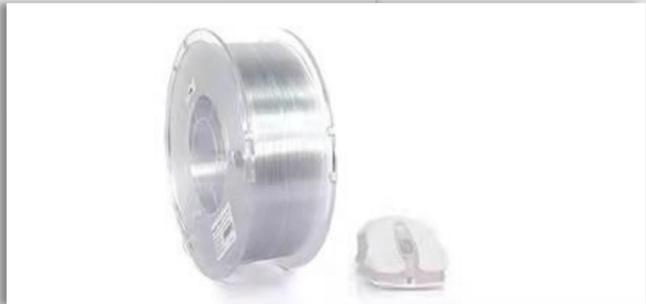
PC (聚碳酸酯) 是一种坚固而且透明的工程热塑性3D打印耗材，其特点是具有高强度，耐热性和阻燃性。PC耗材可以吸收冲击，防止变形或破裂，并在高温（100°C的温度）和火焰下也可以保持尺寸稳定性。由于对打印要求苛刻，PC打印件的抗冲击性与材料热历史和零件设计有关，特别是薄壁类模型需要优化打印参数。PC通常用于生产刚性零件、功能测试、成品零件组装和制造、工装夹具、检具治具。
