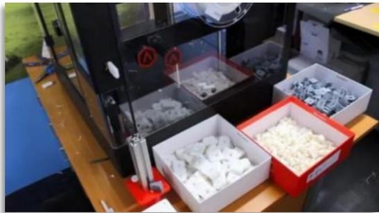
英国GJ塑料公司，通过 Raise3D Pro2 材料挤出工艺3D打印机生产病毒防护面罩组件。
