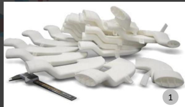
▲ PA12 3D打印零件
